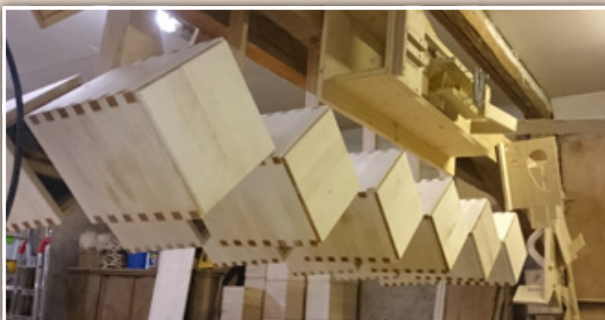
Wässern und Trocknen der Rohlinge
