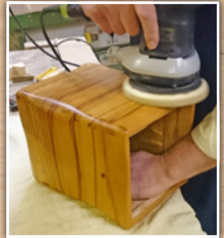
Polieren der geölten Oberfläche
