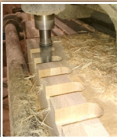
Fräsen der Zinkenverbindungen
